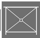
**PRESTIGE**Référence : **BAR3300****Matière** : Acier S235**Main courante** : profil mouluré 40x10 mm**Montants** : Fer plat 30x12 mm**Croisillons** : Carré de 18 mm**Dimensions** : L. 1000 mm, L. 1500 mm, L. 2000 mm**Hauteur hors sol** : 900mm**Thermolaquage** :
